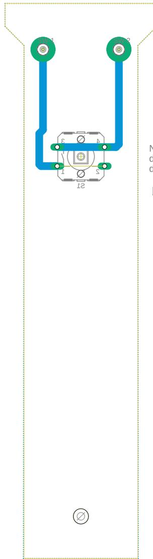
N.B. Lo switch va montato dal lato saldature per consentire di saldare le due basette assieme
